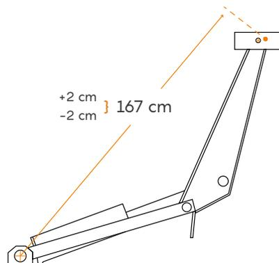
\*Apertura máxima tijera c/cilindro hidráulico.
