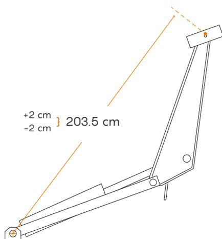
\*Apertura máxima tijera c/cilindro hidráulico.
