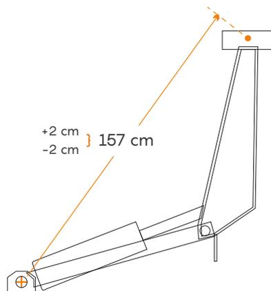
\*Apertura máxima tijera c/cilindro hidráulico.
