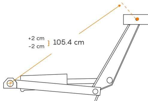
\*Apertura máxima tijera c/cilindro hidráulico.
