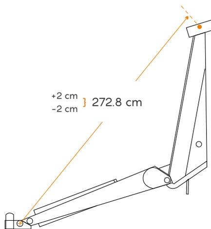
\*Apertura máxima tijera c/cilindro hidráulico.
